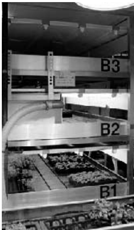
ガラスの向こうは植物工場の設備。植物を工業的に生産することを課題に、スポンジを使い、温度・湿度・栄養分・光量などを一定にして、365日、同じ環境で植物を育てている
