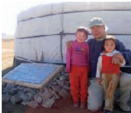
モンゴルに設置した非電化冷蔵庫
