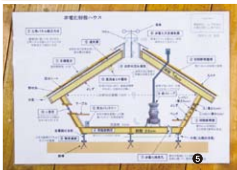
4 非電化籾殻ハウス内部。くつろげる 5 空気は非電化換気孔を通り上部に抜ける 6 断熱床、二重窓、太陽電池、通気層、ファン、風車、ススキ、しっくい、土、薪ストーブ、直流省エネ電球。ヒントがいっぱいの図解
