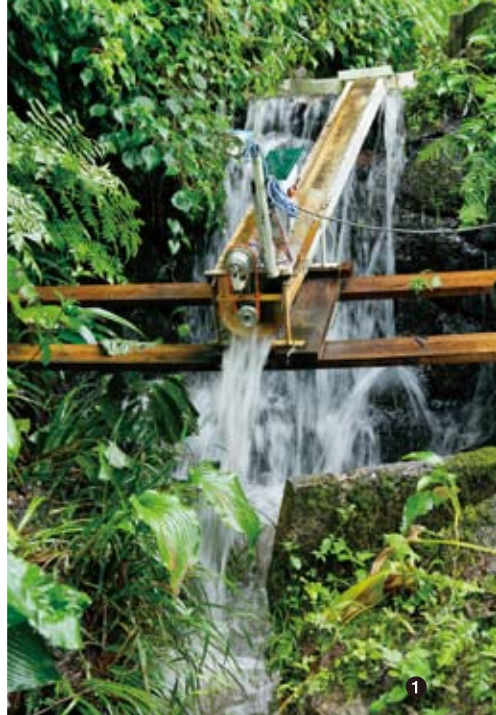
① 「自給自足」の取り組みとして作成した小水力発電機 ② 消費電力の大部分を発生する太陽光発電 ③ 小水力発電をイノシシ除けの電気柵に活用
