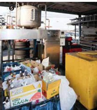
① バイオディーゼル混合軽油の計量機 ② グリーン購入ネットワーク グリーン購入大賞、滋賀CSR経営準大賞などを受賞 ③ 満州事変忠誠録の書籍に「村で評判の藤八油」と紹介されている ④ バイオディーゼル燃料を精製する装置、油蔭商事株式会社オリジナル仕様 ⑤ 各ご家庭より回収した廃てんぷら油と鹿児島から購入した精製装置
