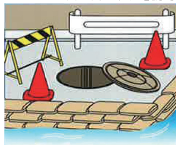
地下鉄、地下道の浸水防止
